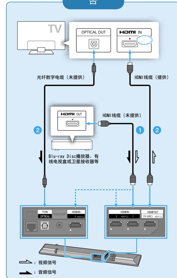
1 将Blu-ray Disc播放器、有线电视盒或卫星接收器连接到有源扬声器上的任意HDMI IN插孔 (HDMI1/2/3)。如果Blu-ray Disc播放器、有线电视盒或卫星接收器等设备当前已与电视机连接, 请断开设备与电视机的连接, 然后将它们连接到有源扬声器, 以再现Dolby TrueHD、DTS-HD、DTS的高质量环绕声。
